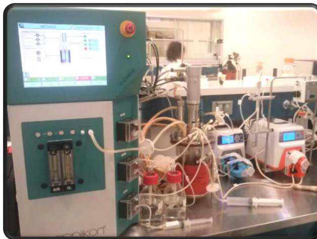
Figura10. Biorreactor Applikon 3L y Sistema ez-control, Applikon.
