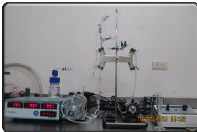
Figura12. Sistema de Ultrafiltración.
