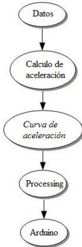
Figura 3.13. Algoritmo del control de velocidad.
