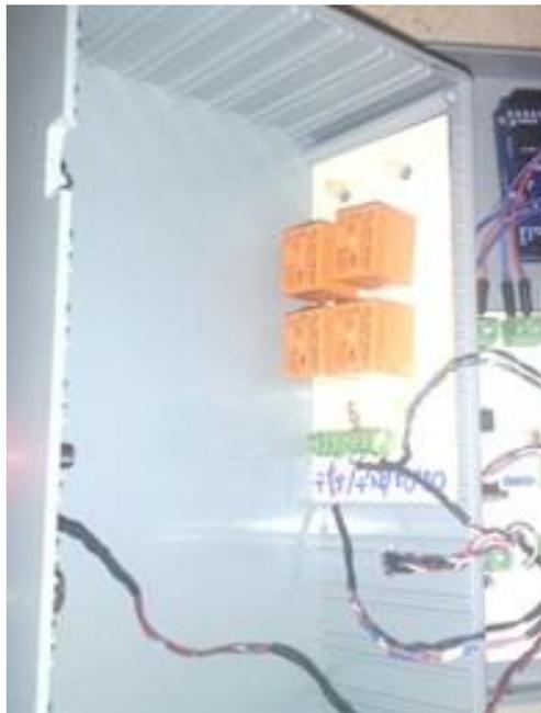
Figura 4.29. *Puente H* posicionado en una de las paredes del gabinete.
