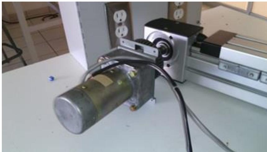
Figura 4.31. Motor ensamblado en el elemento rotativo de la guía lineal.
