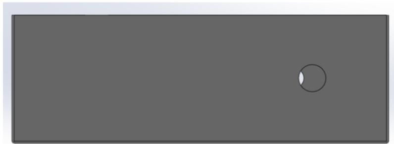
Figura 4.27. Salida para los cables del motor.
