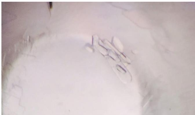
Figura 17. Cristal observado por el método de microbatch en solución amortiguadora MES 100 mM pH 6.5 con Citrato de sodio 1 M; ubicado en el pocillo B2.
