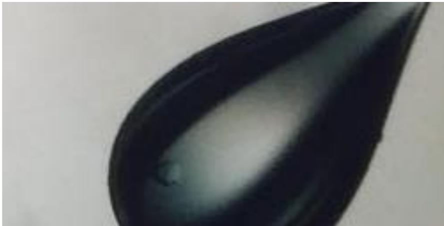
Figura 206. Cristal observado por el método de difusión de vapor (gota colgante) con la condición PEG 8, 000 al 20% p/v con amortiguador HEPES 100 mM, pH 7.5; ubicado en el pocillo B9
