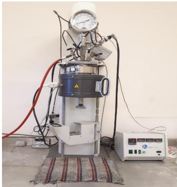
Figura 14. Reactor Parr, laboratorio de procesamiento acuoso.
