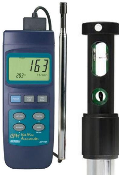
**Figura 18.** Anemómetro de alambre caliente Extech 407119A.
