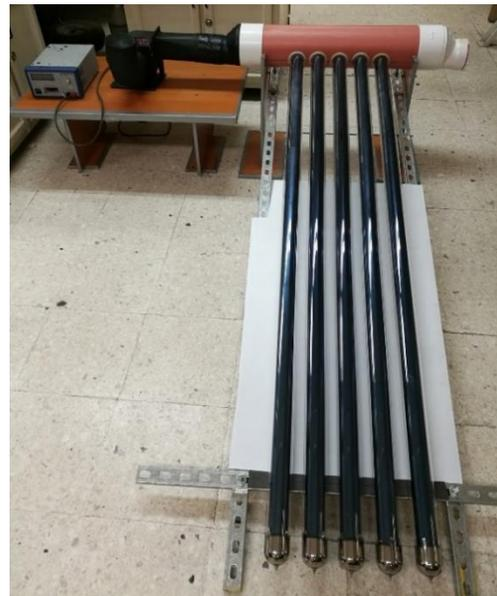
**Figura 19.** Configuración Experimental del Colector Solar.
