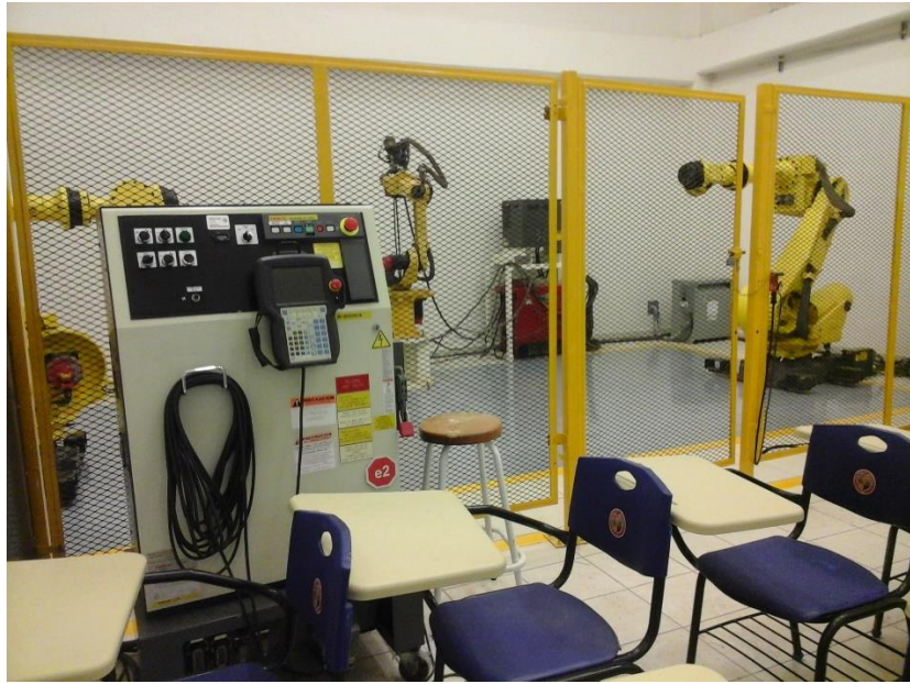
Fig. 18.- Área de los robots terminada con sus líneas de seguridad.
