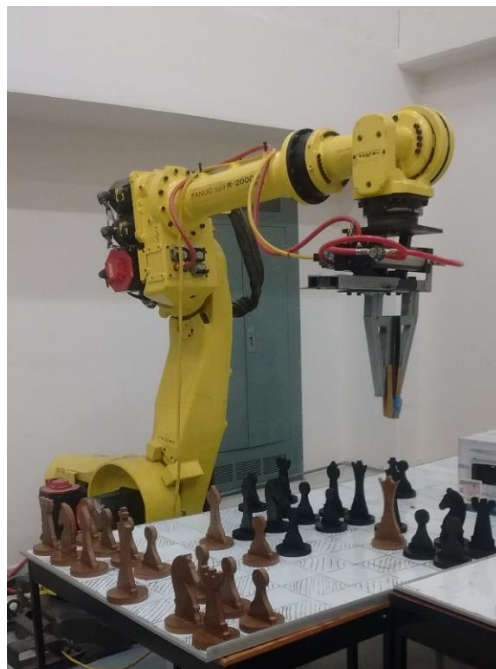
Fig. 23.- Método 1: Programación de coordenadas para movimiento de piezas de ajedrez.
