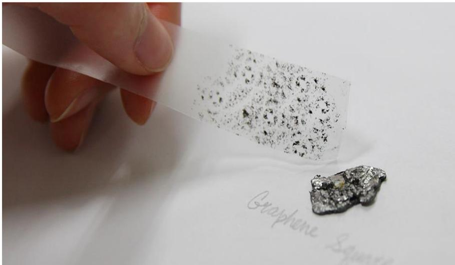
Figura 4. Exfoliación mecánica. Tomada de [www.graphenesq.com](http://www.graphenesq.com)
