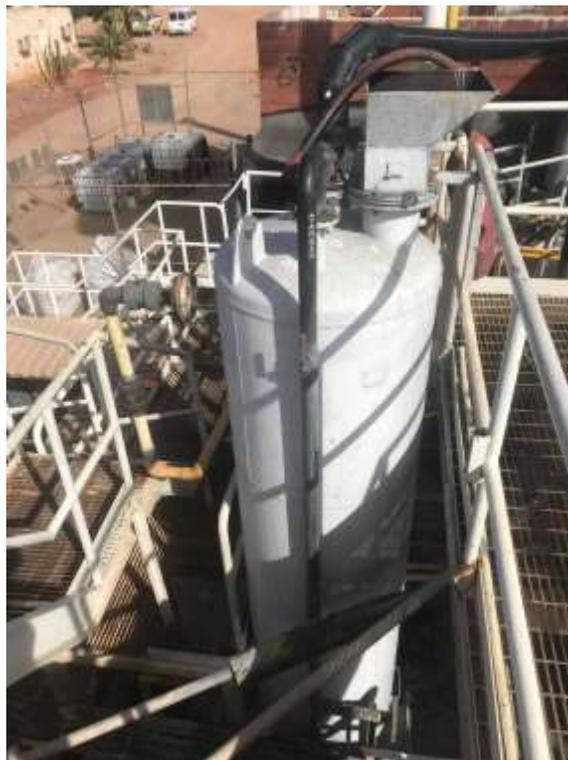
Figura 13. Tanque de lavado ácido.
