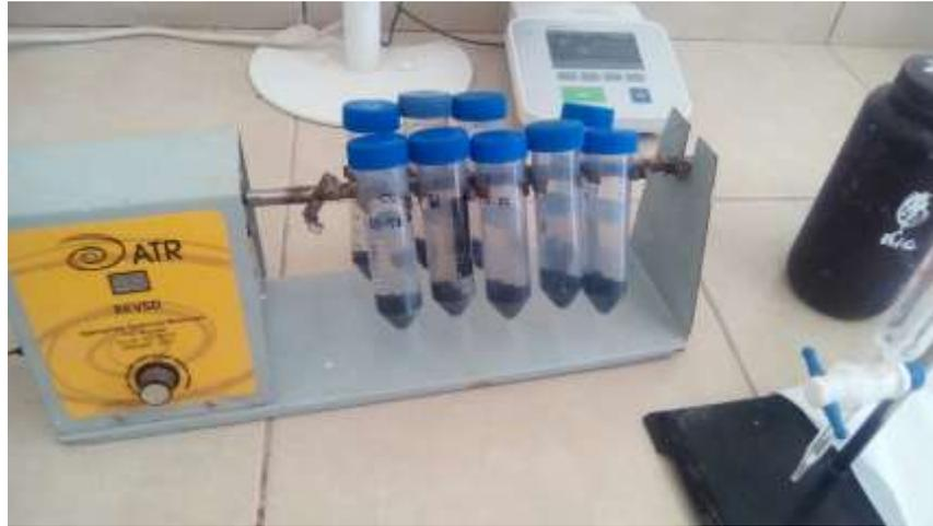
Figura 20. Agitador para determinación de carbonatos.
