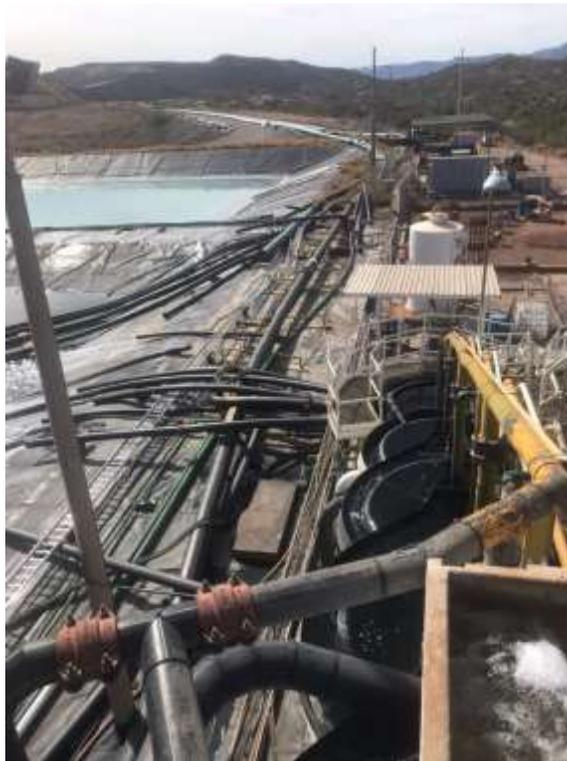
Figura 10. Columnas de adsorción.
