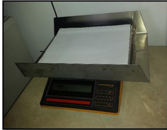
Figura 5. Balanza analítica para medir el peso inicial y final de los filtros.
