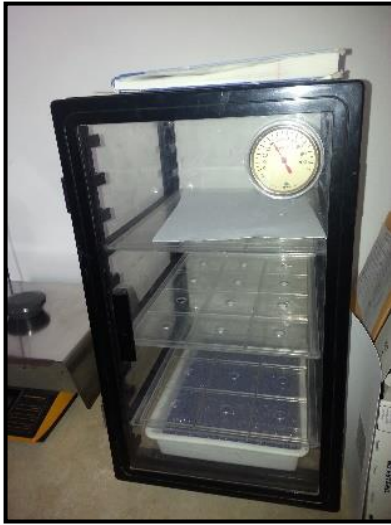
Figura 4. Acondicionamiento de los filtros en deshumidificador.
