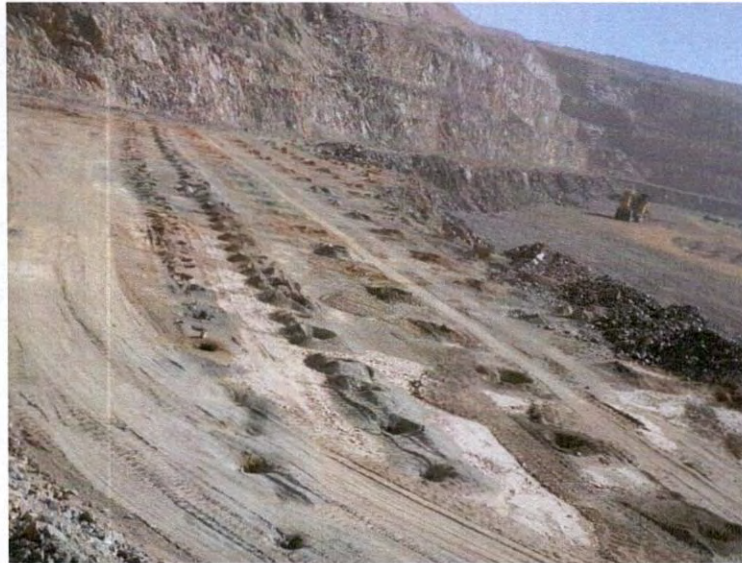
Figura 25.- Plantilla con distintos tipos de barrenación.
