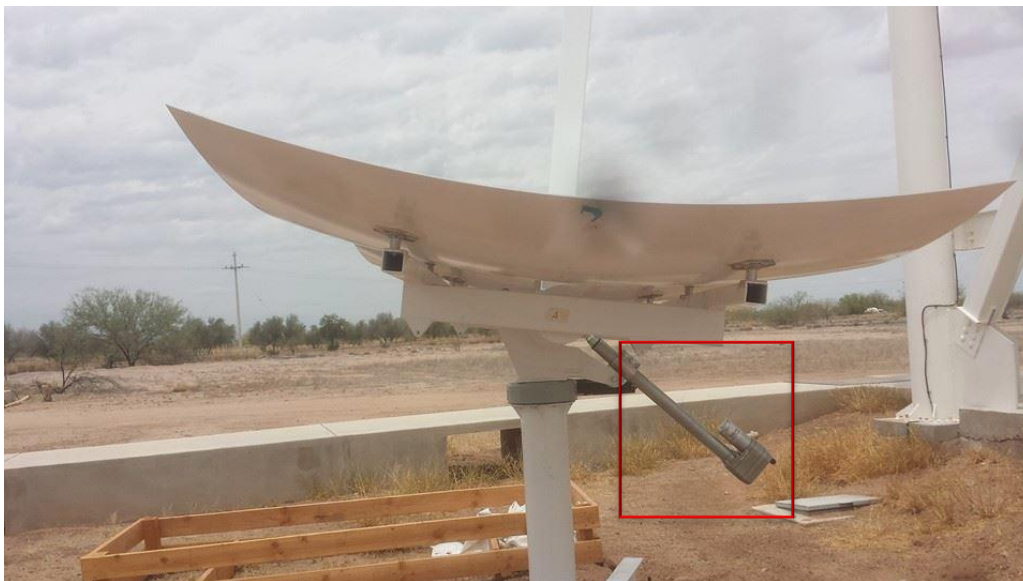
Imagen 4.3: Motor encargado de mover el equipo en el eje de elevación.
