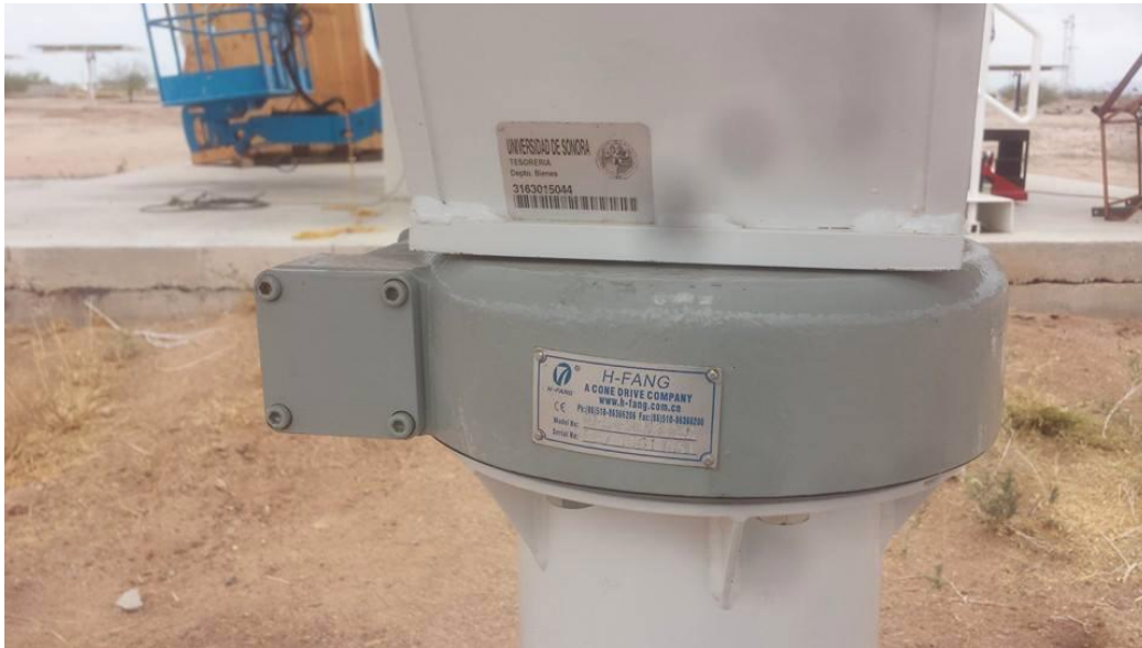
Imagen 4.2: Motor y rotor encargados de girar el equipo en el eje azimutal.
