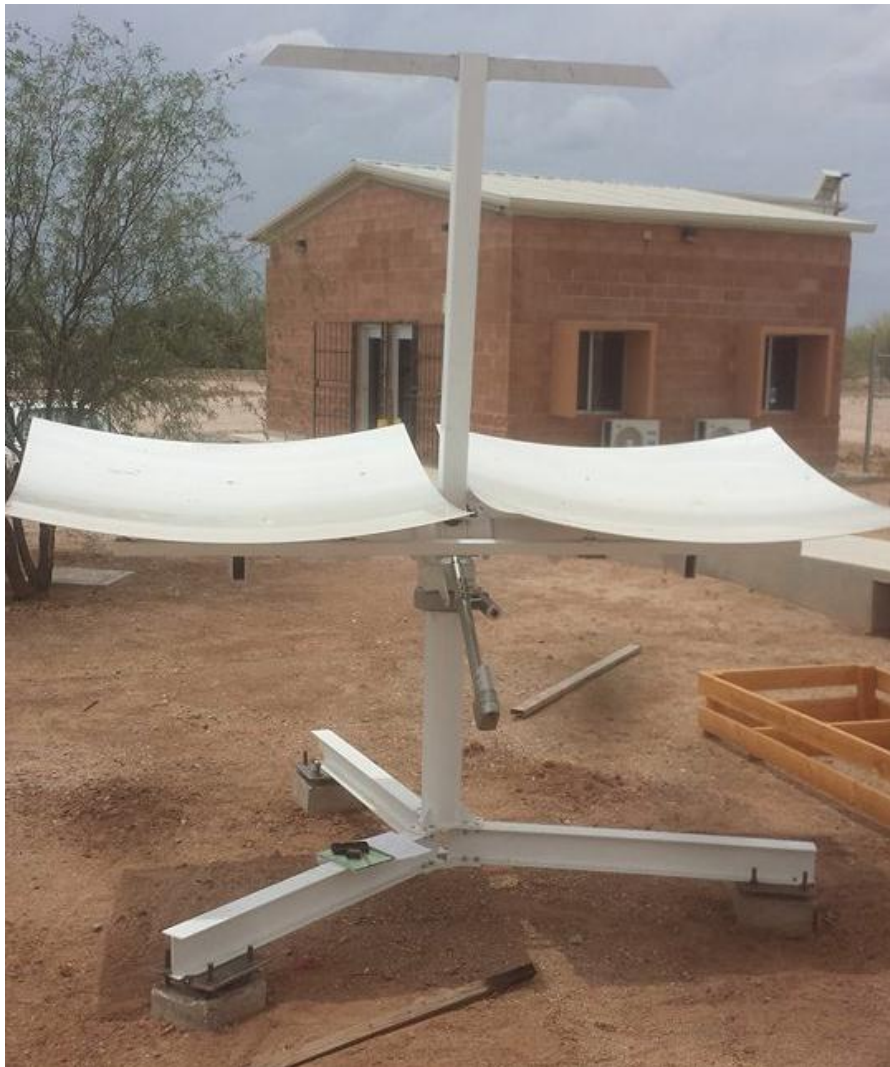
Imagen 4.1: Equipo de concentración solar (estructura metálica, mecánica y facetas)
