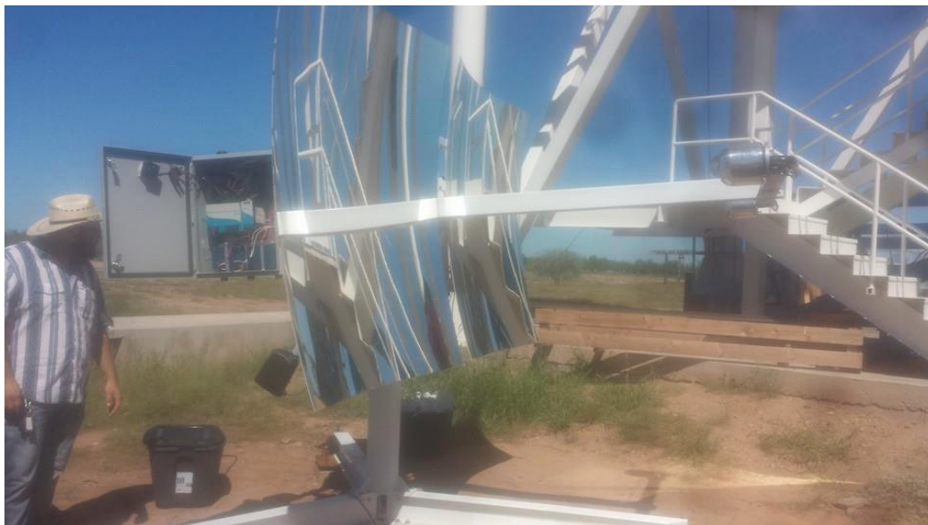
Imagen 2.1: visualización de una faceta en forma de paraboloide elíptico con un punto focal determinado
