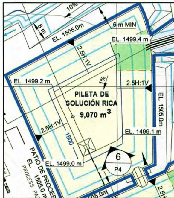
Figura 16: Arreglo general de la pileta de solución rica. (Golder, 2016).
