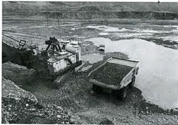
Ilustración 30.- Cargado de camión con pala.
