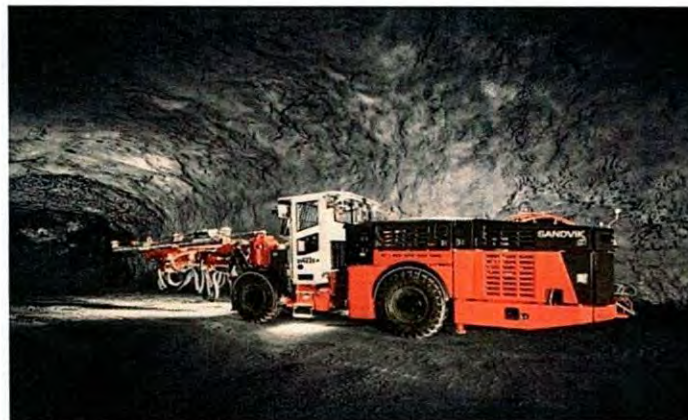
Figura 8. Jumbo eléctrico, funciona por medio un suministro de energía eléctrica.
