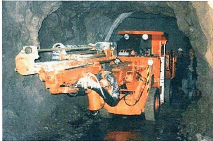
Figura 7. Jumbo autónomo, funciona por combustión a diesel.
