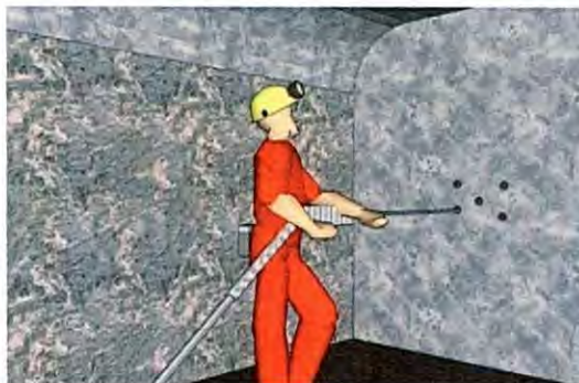
Figura 13. Barrenación horizontal utilizada para avances sobre mineral o tepetate.
