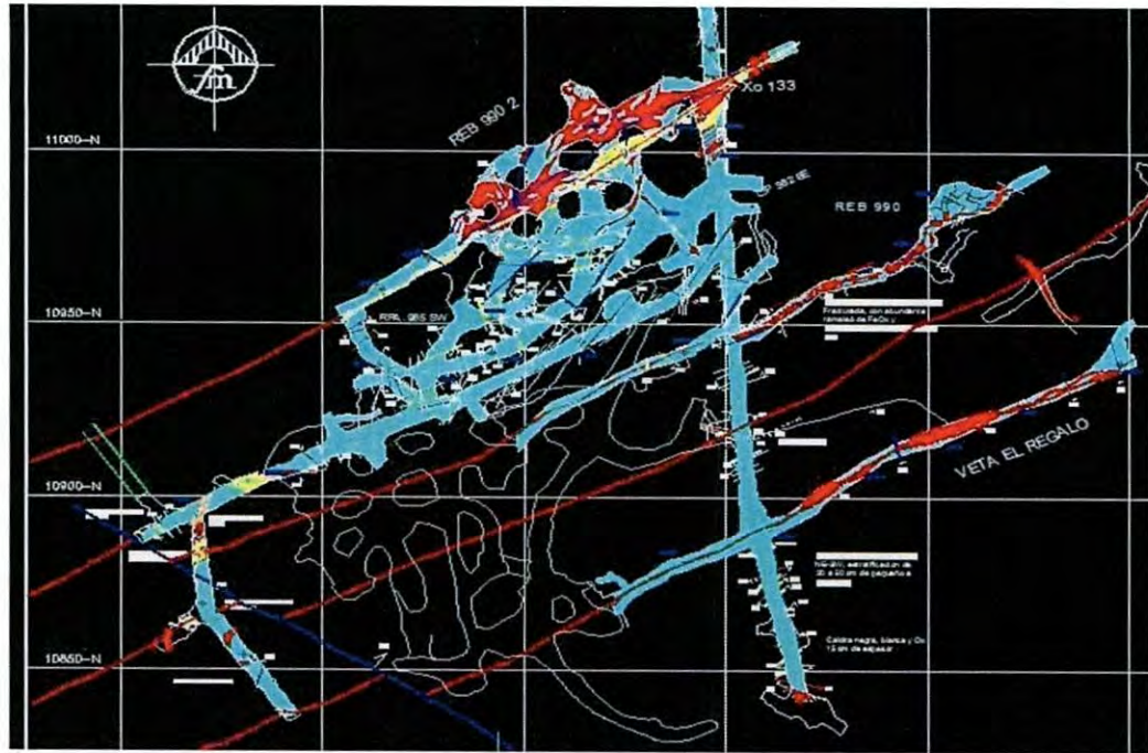
Figura 5. Imagen donde se muestra cada una de las estructuras principales, 990-2, 990, Azul y Oro y El Regalo (Elaborado por el departamento de Geología Unidad Minera La Encantada, First Majestic Silver Corp).
