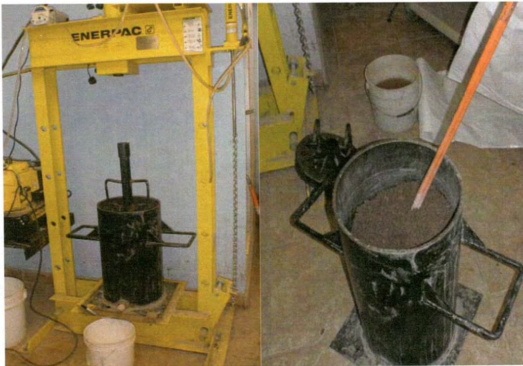
FIGURA 40. Prensa para prueba de resistencia de glomeros en patios.
