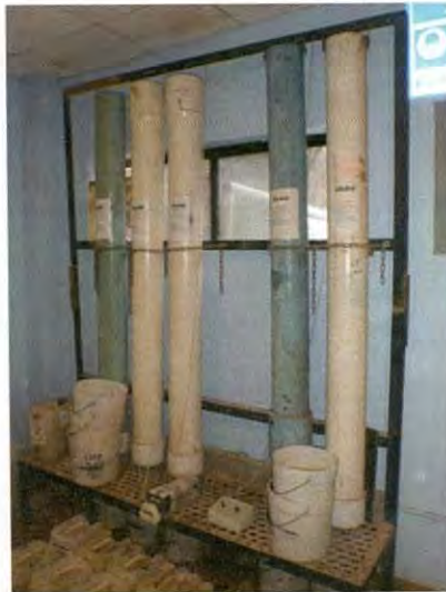
FIGURA 38. Columnas representadas como patios de lixiviación.
