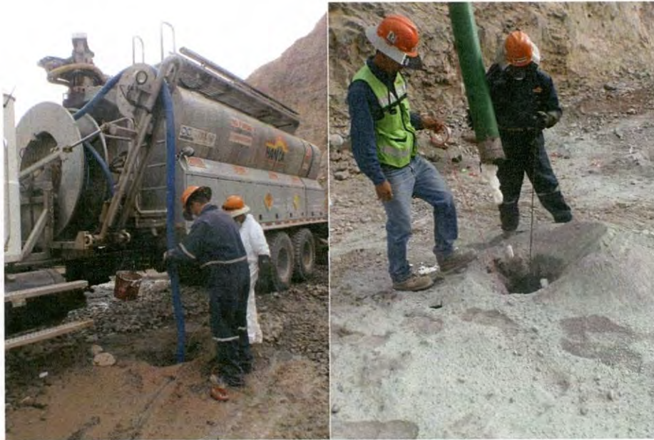
FIGURA 31. Forma de cargado de Anfo, emulsión o mezclas al barreno.
