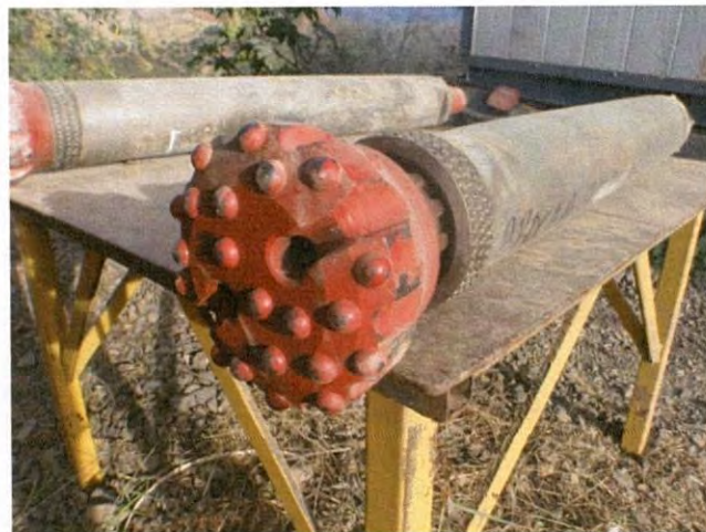
FIGURA 23. Broca de 7 ½ para barrenos de producción.
