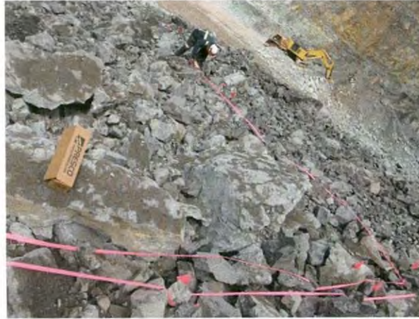
FIGURA 8. Realización de polígono para identificar el mineral.
