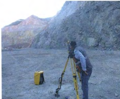
FIGURA 20. Levantamiento de talud con estación total.
