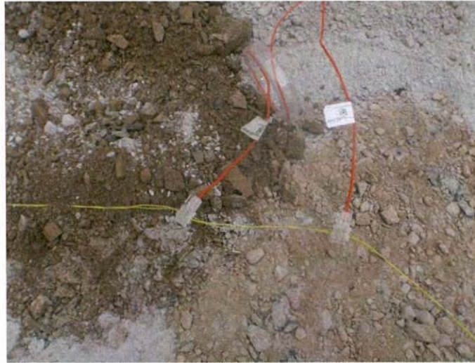
FIGURA 27. Amarre de barrenos a harness.
