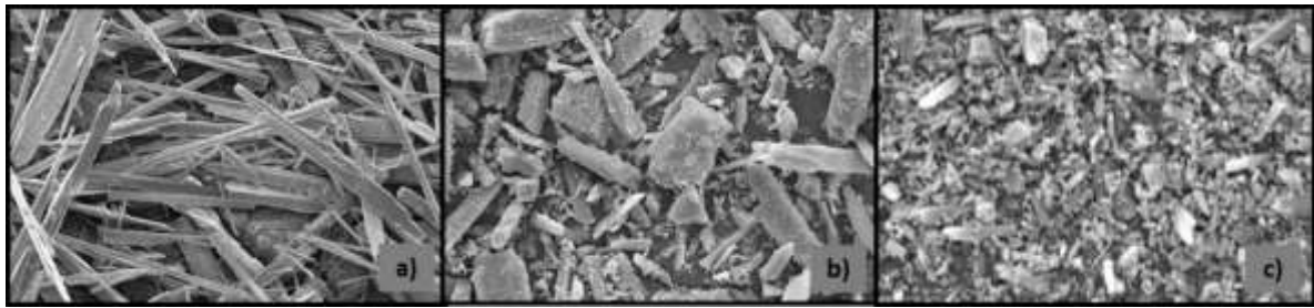
Figura 4. Imágenes de wollastonita. a) Variedad con acicularidad elevada- NYAD G 100x, b) Variedad en polvo- NYAD 400 500x, c) Variedad en partículas finas- NYAD 5000 1000x [22].
