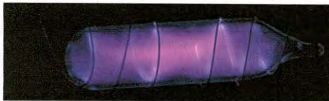
Figura 27. Bulbo con argón brillando.
