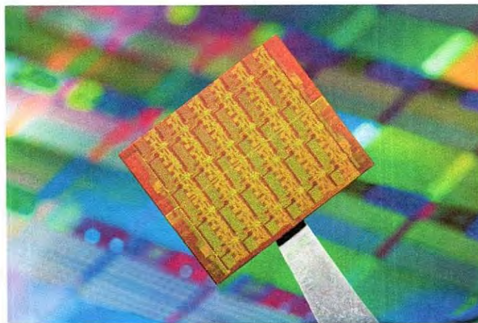
Figura 1. Microprocesador Intel de 48 núcleos.
