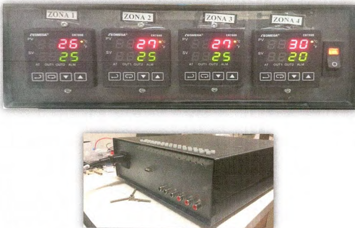
Figura 39. Unidad de Control, panel de temperaturas y parte trasera de conexiones térmicas, válvulas y USB
