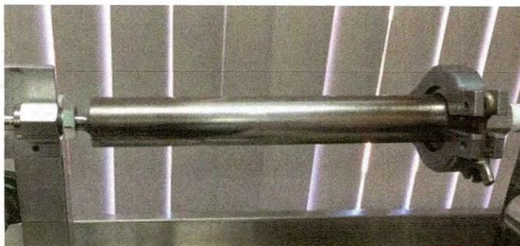
Figura 35. Conexión de la cámara de reacción.
