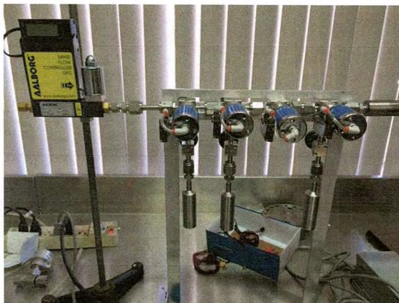
Figura 36. Flujómetro másico en línea con las válvulas ALD.
