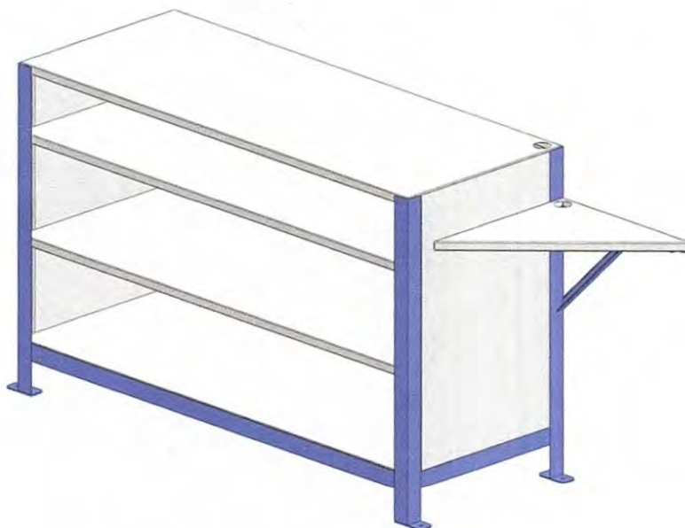
Figura 29. Estructura para montar el reactor ALD.
