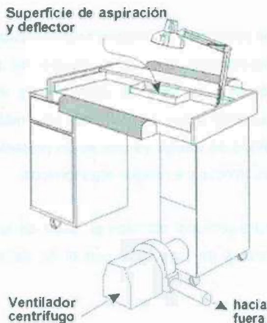
Figura 7. Vista isométrica de la mesa propuesta por la NIOSH
