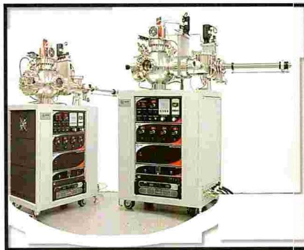
Figura 6 Reactor Hot Filament Chemical Vapor Deposition (HFCVD) de la compañía Blue-Wave.
