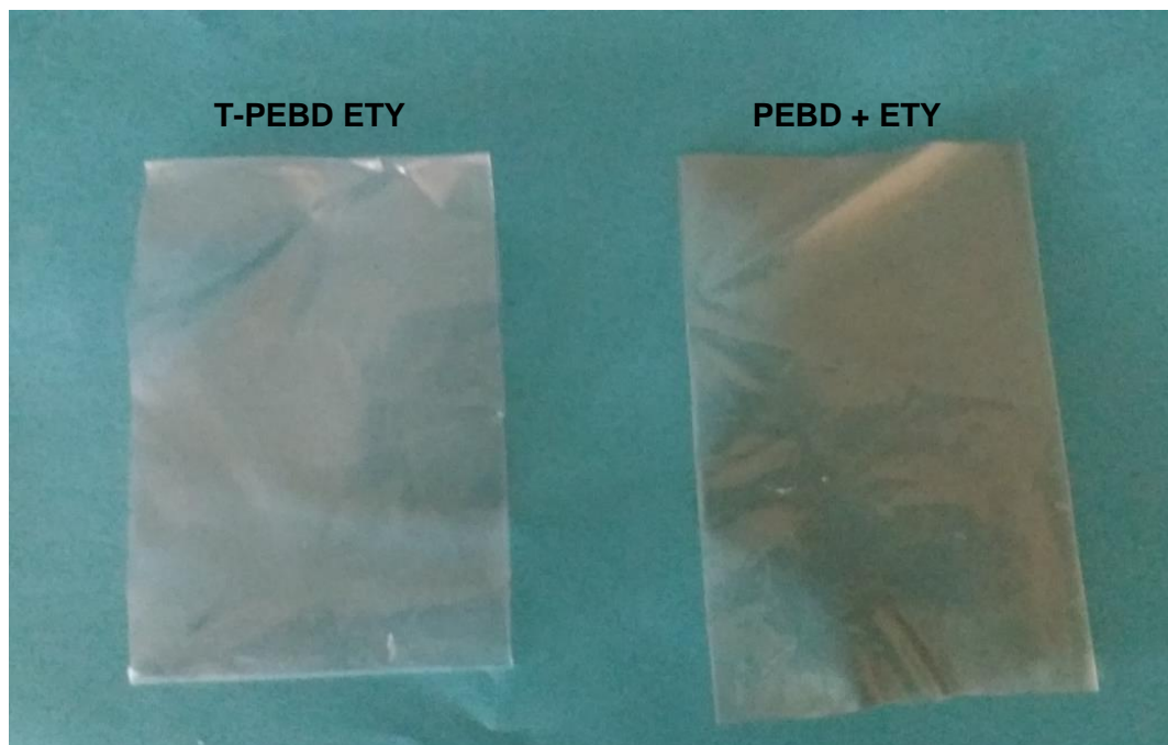
Figura 13. Testigo de la película de polietileno de baja densidad con extracto de tallo de yuca (T-PEBD ETY), Polietileno de baja densidad con extracto de tallo de yuca (PEBD + ETY).
