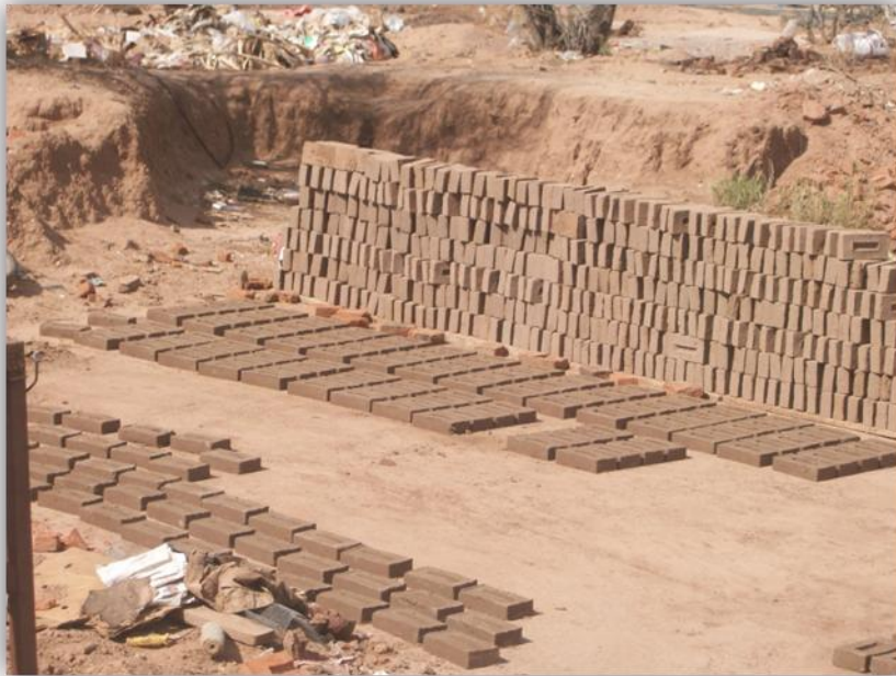
Figura 3.- Secado del ladrillo
