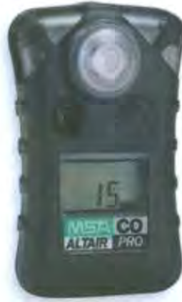
Figura 2. Detector de monóxido de carbono marca MSA tipo AltairPro.
