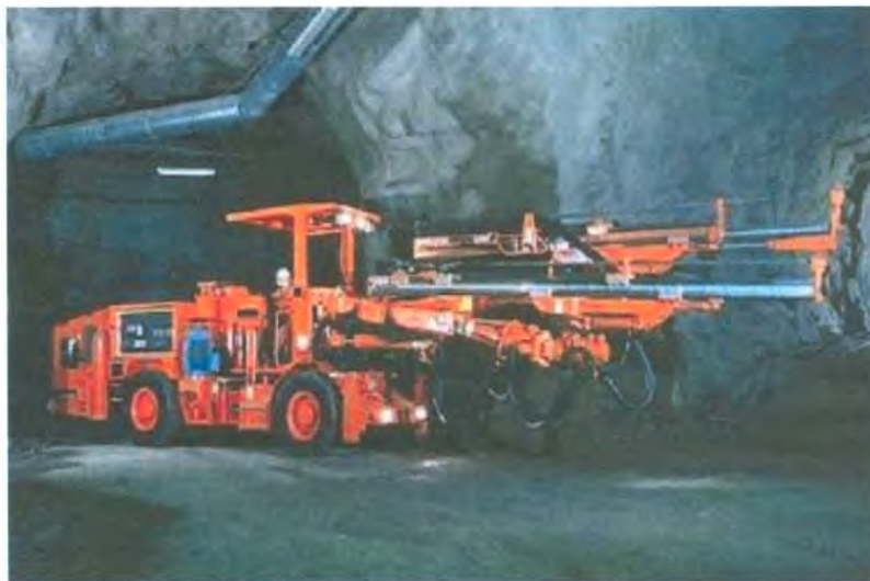
Figura 13. Jumbo utilizado para perforaciones interior mina.
