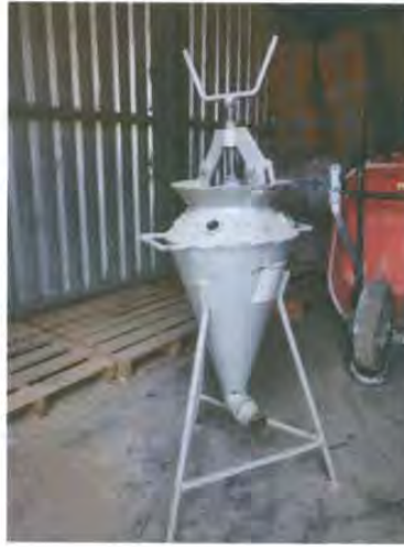
Figura 18. Fotografía de olla para carga Mexamon con aire comprimido.
