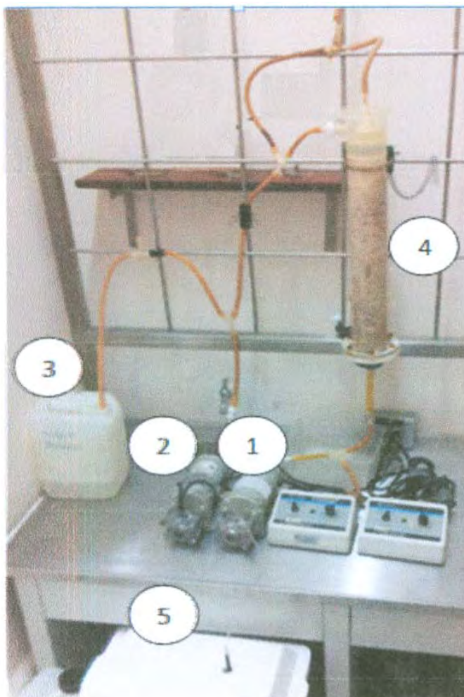
Figura 3. Reactor anaerobio acidogénico con biomasa inmovilizada en clinoptilolita, con recirculación.
