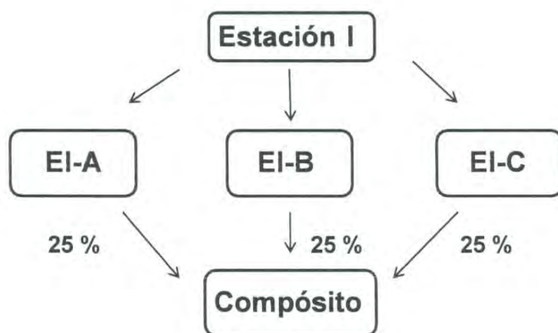
Figura 4. Procedimiento de la obtención de una muestra compósito a partir de tres muestras de una estación.
