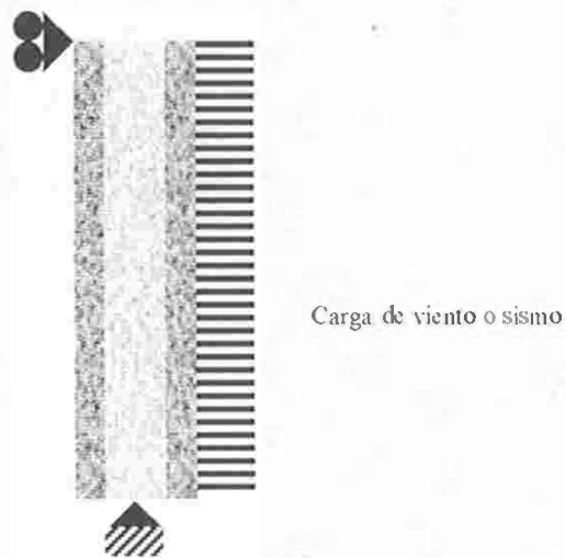
Fig. 2.9, muestra condiciones de apoyo para muro esbelto
