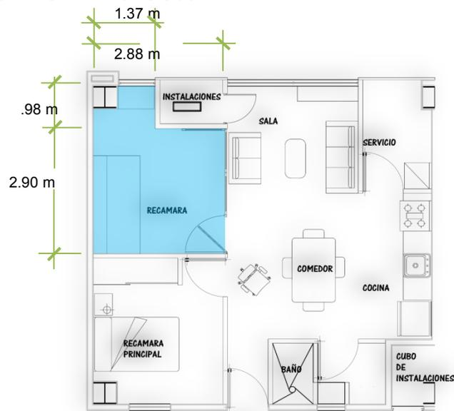
Imagen 2.8 Área de recámara para cálculo de refrigeración
