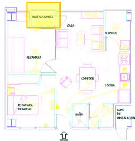
IMAGEN 2.6 Área de refrigeración, para cálculo de circuitos secundarios
