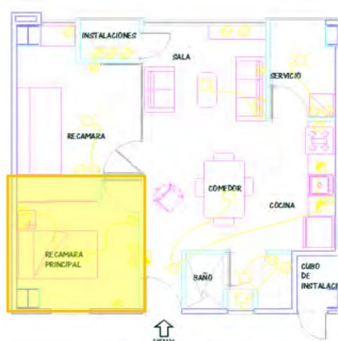
IMAGEN 2.3 Área de recámara principal. para cálculo de circuitos
