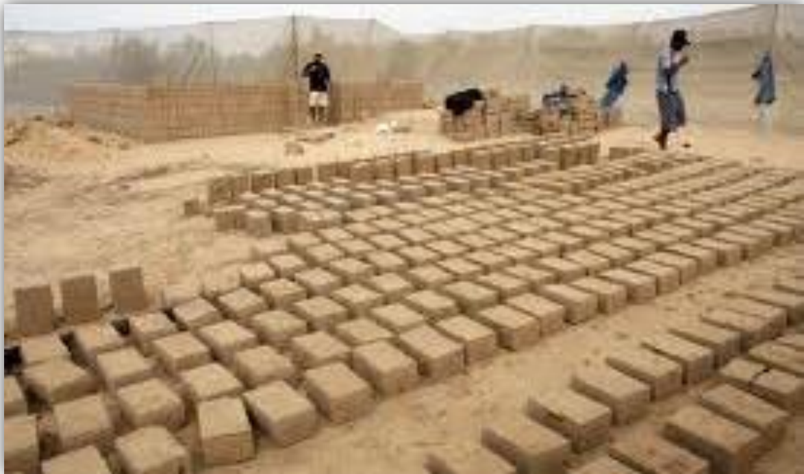
Ilustración 5 Elaboración de adobe, sistema constructivo más característico de la región. Fuente: http://www.ecoportat.net
