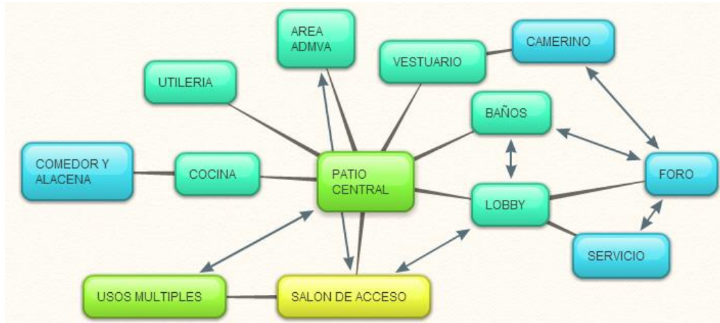
Imagen 49 Diagrama de funcionamiento (Barragán 2014)
