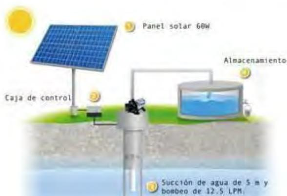
Ilustración 92. "Rebombeo solar". Fuente: [solarmax.com](http://solarmax.com)
