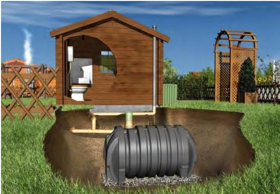
Ilustración 94. "Fosa séptica". Fuente: [desatascos.es/vaciado-y-limpieza-de-fosa-séptica](http://desatascos.es/vaciado-y-limpieza-de-fosa-séptica)
