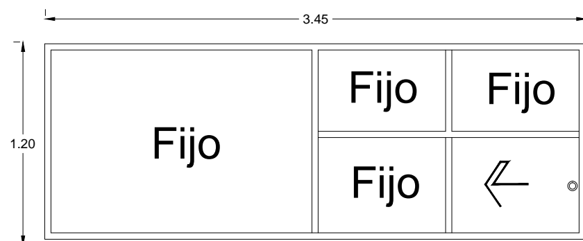
Ventana con 4 divisiones fijas y una de corredera de doble cristal con marco de aluminio color natural
