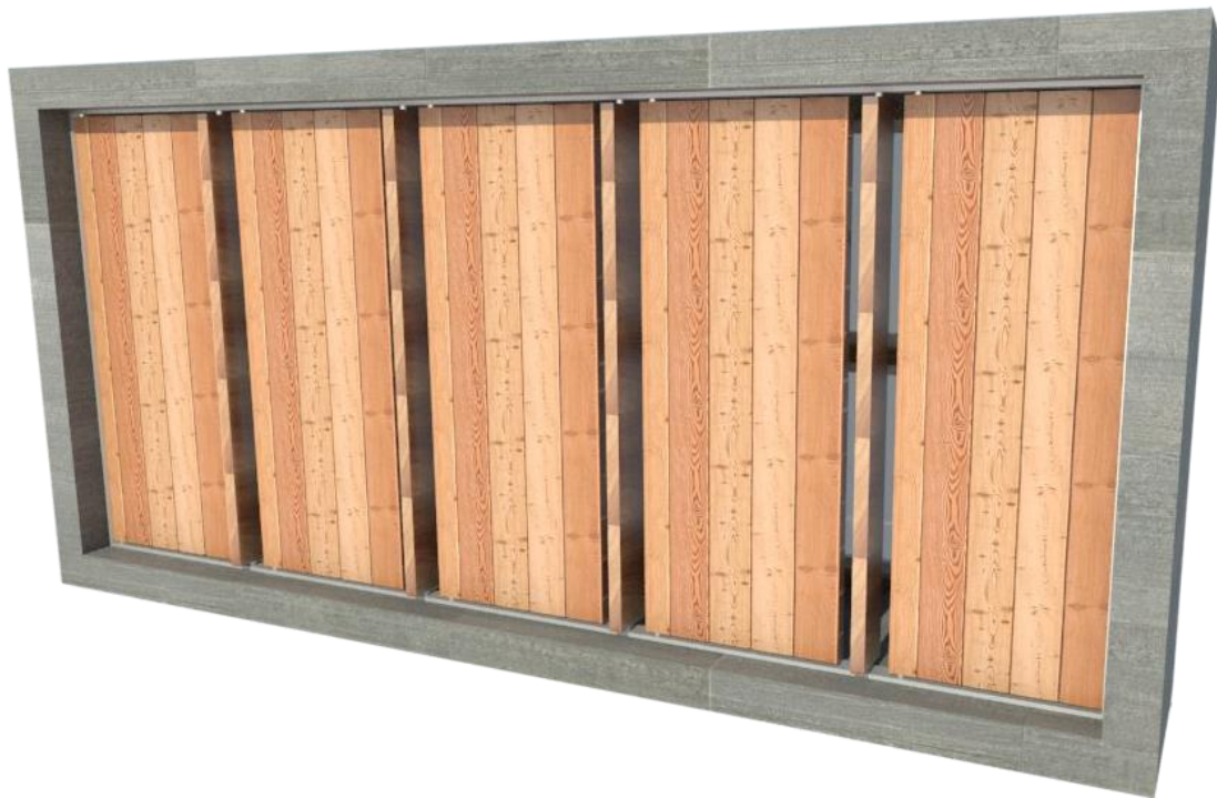
Imagen 39-Ventana Con Persianas a 90 Grados De Abertura En Persiana Pequeña Fuente: Elaboración Propia, 2016
