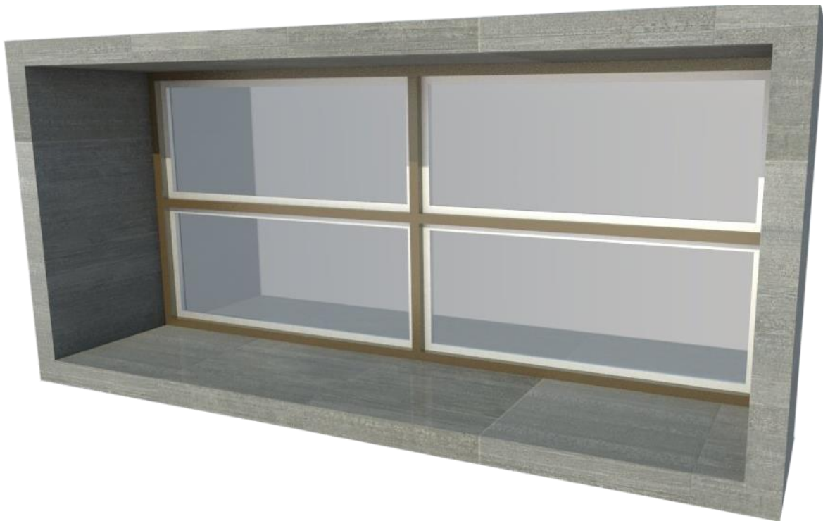
Imagen 37-Ventana Con Cornisa Protectora Fuente: Elaboración Propia, 2016
