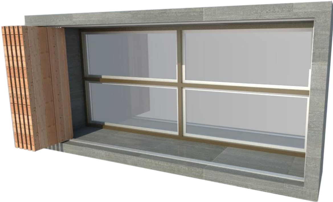
Imagen 42-Ventana Con Persianas a Total Abertura Fuente: Elaboración Propia, 2016
