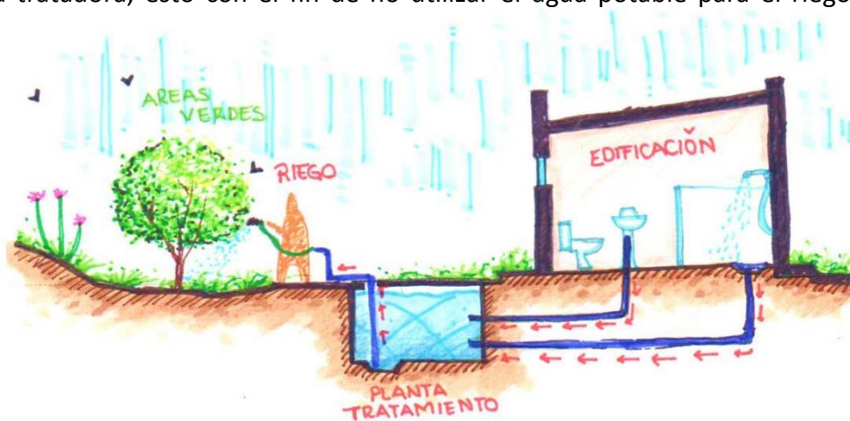
Imagen 2.5 Reutilización de aguas grises para riego. Fuente: Archivo Propio S/E
