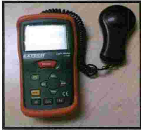
Figura (3-2). Luxómetro LT300, usado para la realización para las medidas de iluminación en el área de estudio [Referencia 12].
