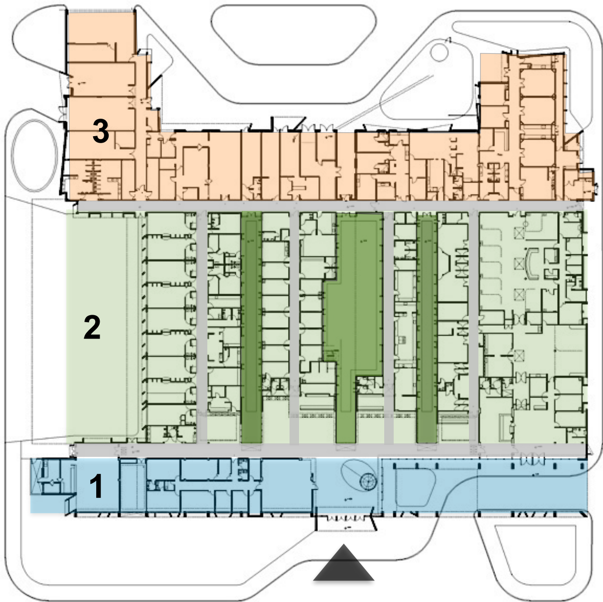
Imagen 8. Planta arquitectónica del hospital municipal en Villa Libertador. Se representan los 3 tipos de áreas: en azul espacio público, en verde semipúblico y en anaranjado técnico. arqa.com
