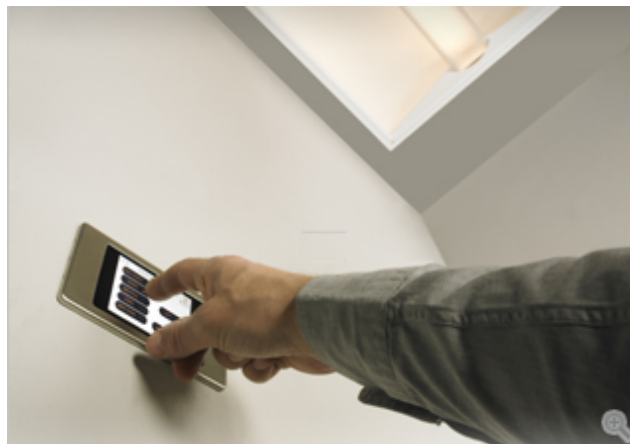
Imagen 26. Sistema de control de iluminación
