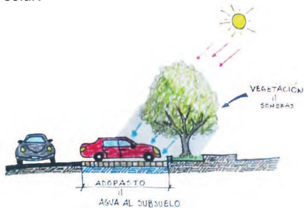
Imagen 3.5. Disminución de la incidencia solar utilizando adopasto en el estacionamiento. Fuente A.C.
