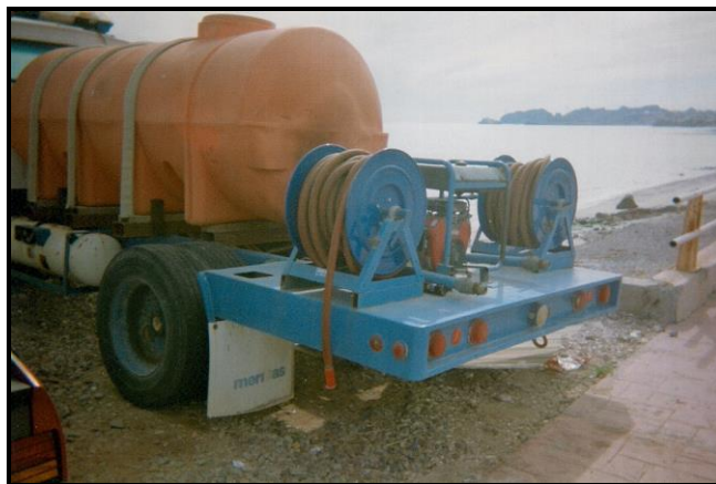
Figura 11. Equipo de Bombeo y mangueras
