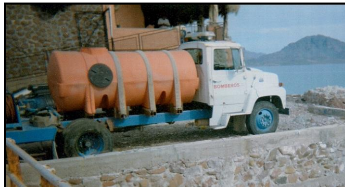
Figura 10. Vehículo auto bomba improvisado
