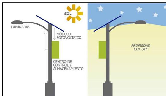
Ilustración 2. Elementos de una luminaria de celda solar, y su funcionamiento.
