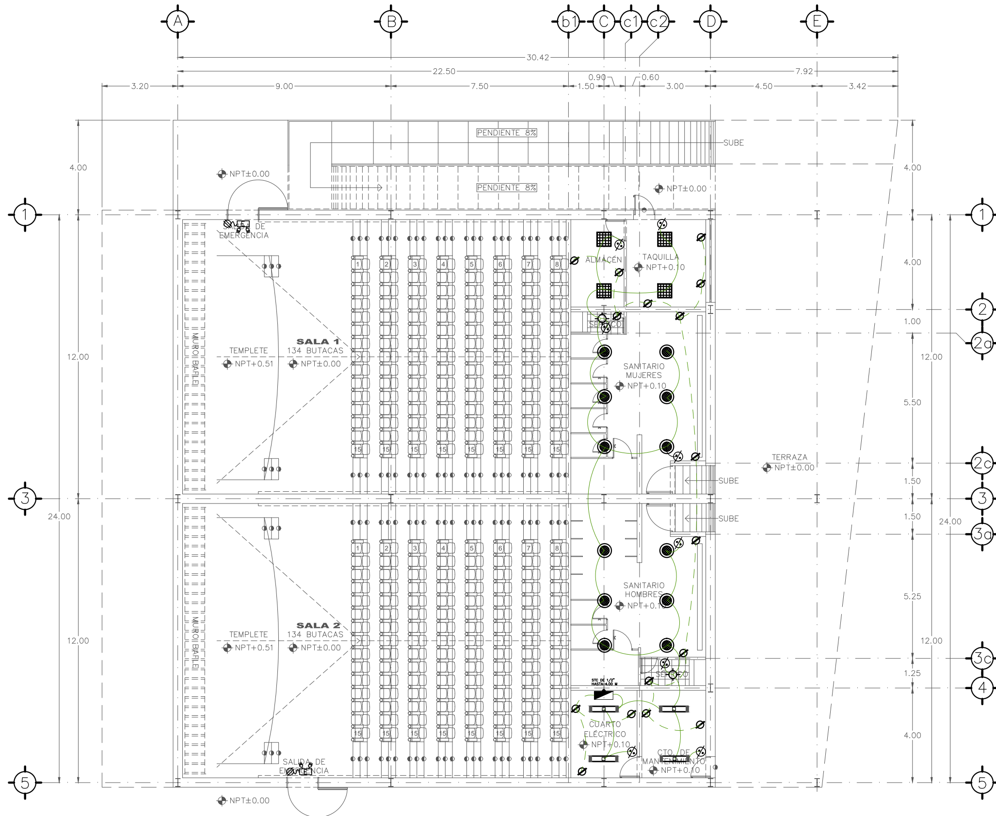
INSTALACIÓN ELÉCTRICA NIVEL PRINCIPAL ESC. 1:150
