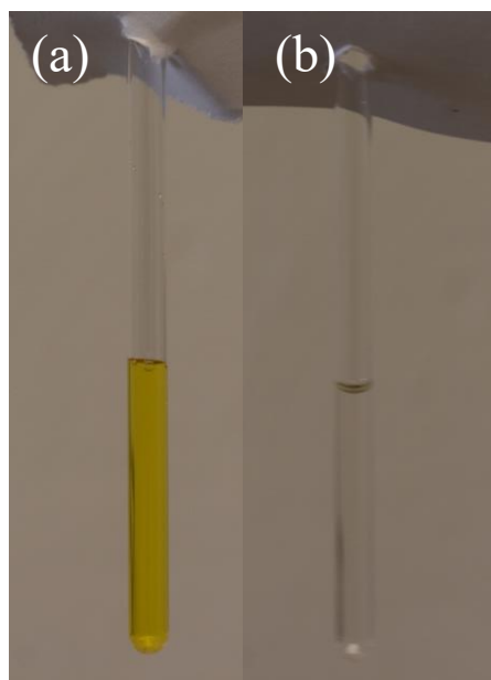
Figura 19. Muestras de RMN de: (a) el producto obtenido de la bioconjugación por EDC y (b) el producto obtenido de la bioconjugación por DCC.
