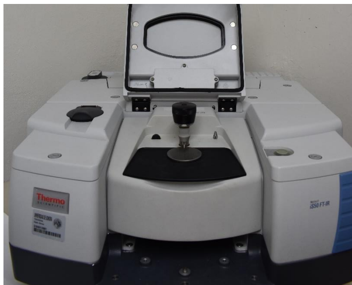
Figura 10. Equipo de espectroscopía FT-IR con módulo ATR.
