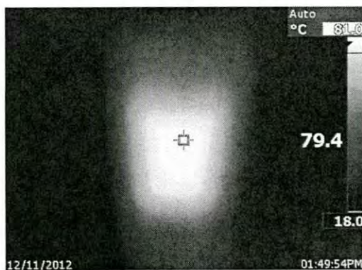
Figura 4.7 Termograma con enfoque deficiente.
