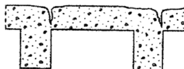
Fig. 8.11. Descripción Esquemática de Agrietamiento plástico por asentamiento.
