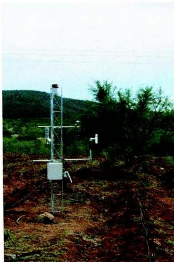
Figura 10.- Estación meteorológica automatizada, en sitio experimental de Mátape, Sonora.
