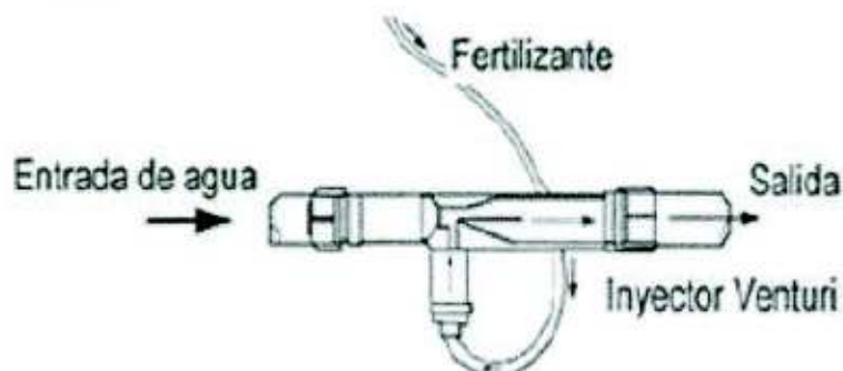
Figura 7. Inyección por medio de un Venturi
