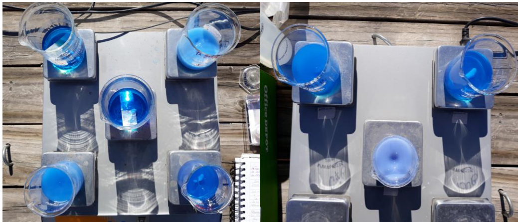
Figura 17. Muestras en proceso de degradación bajo luz solar a tiempo 0 minutos.
