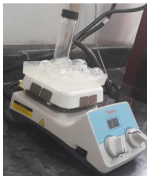
Figura 11. Preparación de síntesis sol-gel de \text{TiO}_2 .
