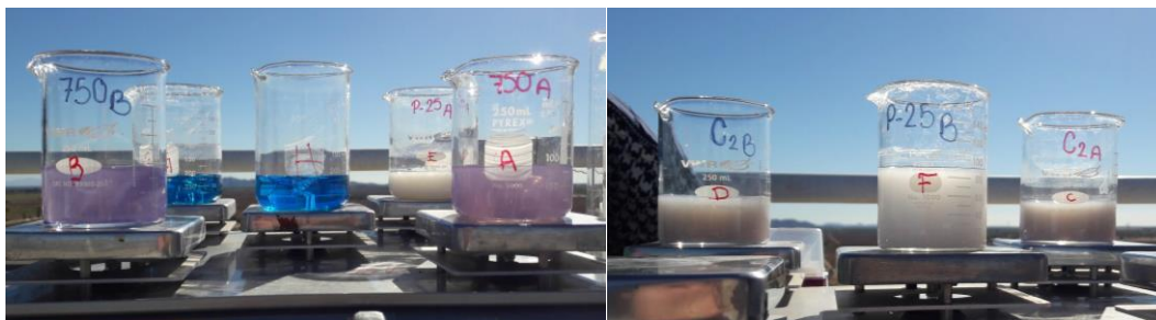
Figura 18. Muestras en proceso de degradación bajo luz solar a tiempo 105 minutos.
