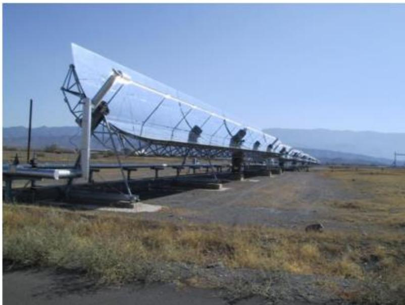
**Figura 2.2.** Sistema de concentración térmica. Canal parabólico (CSP) (Camacho, Berenguel y Gallego, 2014)
