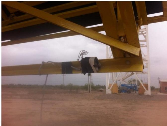
**Figura 4.21.** *Módulo Arduino y sensor fijados en la estructura del helióstato.*
