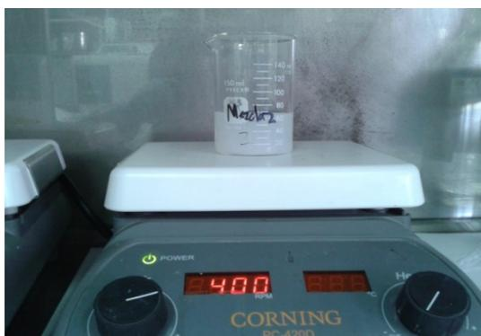
Figura 21. Solución bajo agitación magnética a 400 RPM, después de 30 minutos de reacción se observa la formación coloidal y gelación.
