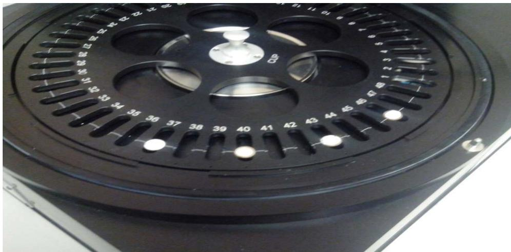
Figura 23. Carrete del sistema Risø donde se muestran polvos sintetizados sobre los portamuestras.
