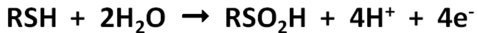
Figura 10. Reacción de grupos tiol con compuestos de rutenio. Reacción propuesta que se promueve en presencia de compuestos de rutenio tras la formación de grupos tiol. (Fuente: Cox y Gray, 1990)
