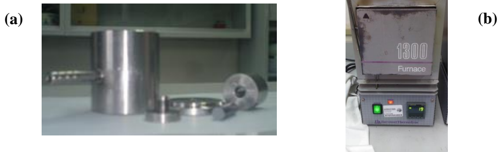
Figura 13. Equipo utilizado para la obtención de las pastillas de ZnO tratadas térmicamente: (a) molde para fabricar pastillas de un diámetro de 7 mm, y (b) horno Thermolyne 4000 y crisol de alúmina utilizados para llevar a cabo los tratamientos térmicos de las pastillas de ZnO.
