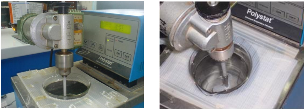
Figura 12. Baño a temperatura constante y agitador mecánico para llevar a cabo la síntesis de polvo de ZnO.
