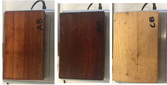
Figura 16. Estado final de muestras con barniz
