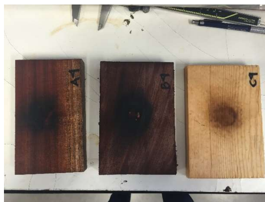
Figura 14. Estado final de muestras sin barniz
