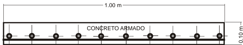
Figura 2. 19 Sección unitaria de TCR y refuerzo de acero corrugado.
